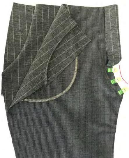
Klappe den Beleg für den Untertritt nach innen, so dass er jetzt links auf links liegt. Lege jetzt beide Vorderteile rechts auf rechts aufeinander und stecke die kurze Schrittnaht zusammen.
