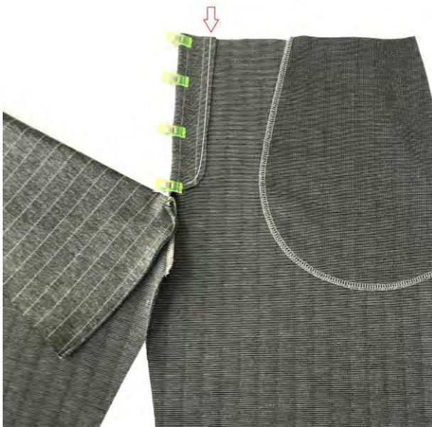
Klappe den Übertritt des rechten vorderen Hosenbeins nach innen um. Der Knick verläuft genau in der Verlängerung der Schrittnaht. Steppe jetzt den umgeklappten Übertritt knappkantig entlang der Rundung fest.
