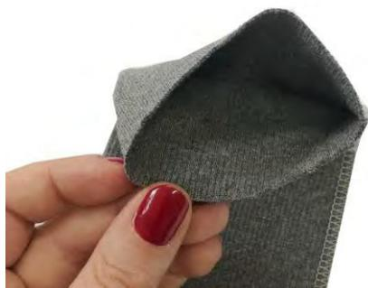
Schließe die Naht, du erhältst einen langen Bündchenschlauch.
