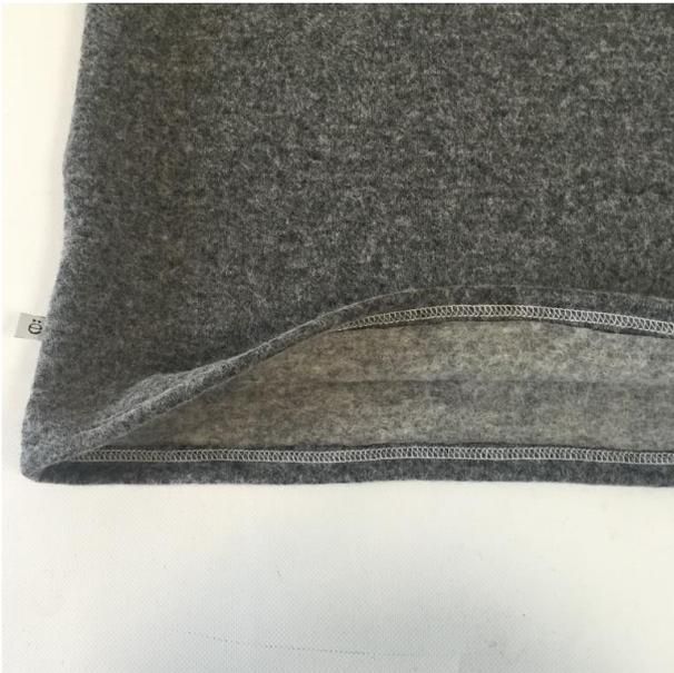
Dann steppst du sie mit einem dehnbaren Stich deiner Nähmaschine oder der Coverlock ab.
