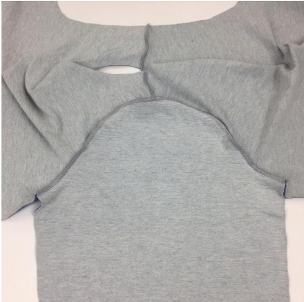
Nähe den Ärmel jetzt mit einem dehnbaren Stich deiner Nähmaschine oder der Overlock in den Armausschnitt.
