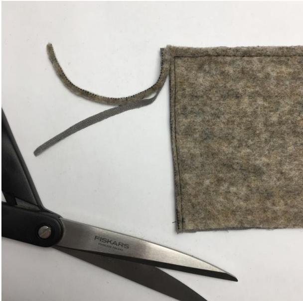
Schließe die drei Kanten mit einem Geradstich deiner Nähmaschine und schneide anschließend die Nahtzugabe knappkantig bis an die Naht heran weg. Achte gut darauf, dass du dabei die Naht nicht versehentlich einschneidest!
