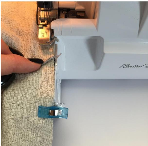
Schließe die Naht nun mit einem dehnbaren Stich deiner Nähmaschine oder der Overlock.
