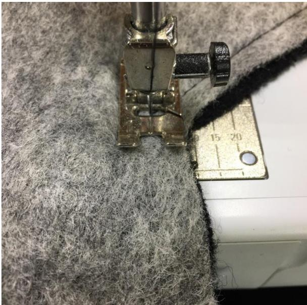
Nähe nun den Beleg etwa füßchenbreit entfernt von der Kante einmal rundum mit einem Geradstich deiner Nähmaschine auf den Halsausschnitt.
