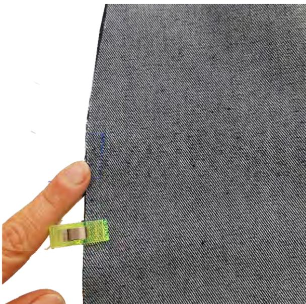
Nähe ab der Reißverschlussmarkierung nach unten etwa 3cm mit einem Geradstich der Nähmaschine zusammen. Das ist wichtig, da die Nahtzugabe auseinander gebügelt werden muss.
