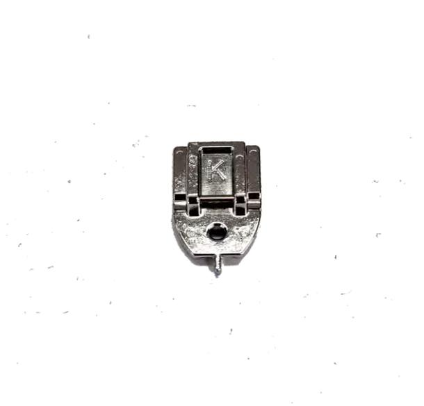
Für das Einnähen eines nahtverdeckten Reißverschlusses benötigst du ein spezielles Nähmaschinenfüßchen. So sieht dieses für eine brother Nähmaschine aus.
